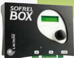
HF-BOX2 trasmettitore di informazioni autonomo, comunicante via radio su frequenza libera. Dispone di 6 ingressi di tipo digitale (di cui 2 utilizzabili per i conteggi) e di 2 ingressi analogici e trasmettono queste informazioni alla S500 remota. Costituisce una soluzione particolarmente adatta agli asservimenti tra serbatoi e stazioni di pompaggio.
